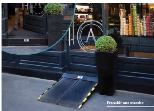
Exemple d'une rampe amovible
