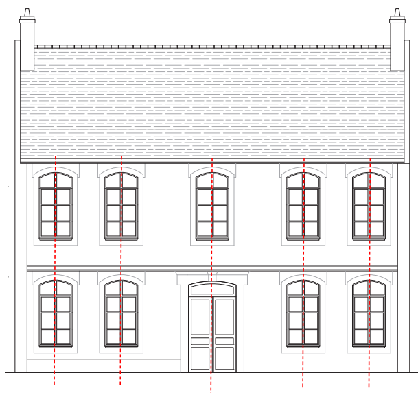
Façade ordonnancée à cinq travées
