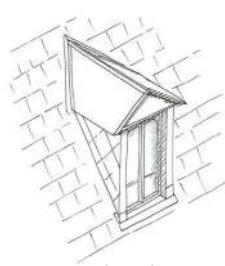
Lucarne pignon bâti en bois
