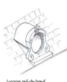
Lucarne œil-de-bœuf Encadrement en pierre moulurée et habillée en zinc
